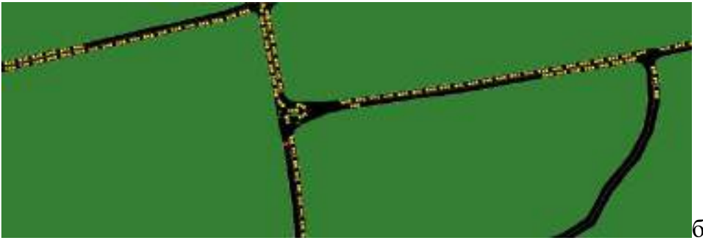
Рис. 2. Фрагменти симуляції руху транспорту в середовищі SUMO: а – транспортний затор на перехресті в сценарії збільшення інтенсивності руху на 50 % у порівнянні з базовим; б – поширення заторів в сценарії перекриття ділянки дороги
